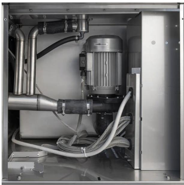
Per garantire la massima igiene della macchina, le pompe sono installate in verticale così da scaricare completamente l'acqua residua, eliminando il rischio di pericolosi ristagni. La loro potenza varia dai 2,6 ai 2,9 kW. Per particolari esigenze è possibile installare pompe in acciaio inox da 3 kW (optional).
